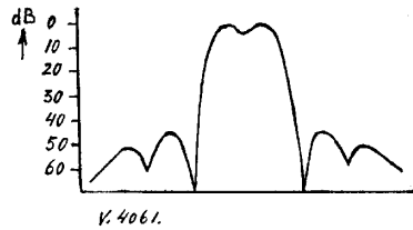
Fig. 21. Karakteristiek van een filter met twee secties, bij te sterke neutrodynisering
